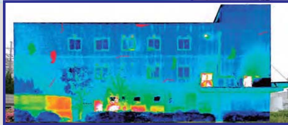
赤外線画像と可視画像の合成(劣化箇所の検出)
